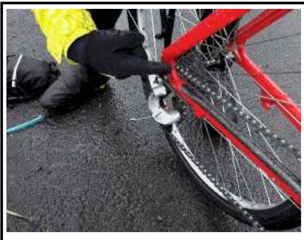
Ajuster la manette de vitesse pour que la chaîne aille sur le plus petit engrenage. Ouvrir la manette du déclenchement rapide ou enlever les écrous
